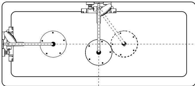
Showerpipe можно с легкостью установить на короткой или длинной стене над ванной – в зависимости от расположения подводов воды. Расположение верхнего душа при этом можно подкорректировать, повернув его в нужную сторону.
