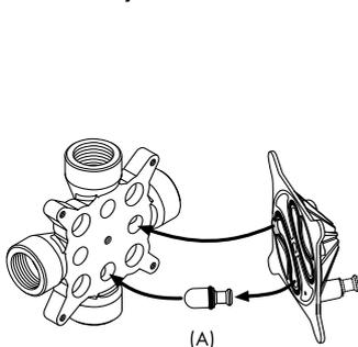
**iBox universal в сочетании с изливом для ванны Exafill с бортом для слива /перелива:** перекройте подачу воды к Exafill на время монтажа!
