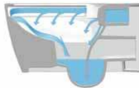
Einwandfreie Beseplung der Innenfläche, Perfect flushing of the inner surface. Sciacqua ottimale dell'interno del vaso.
