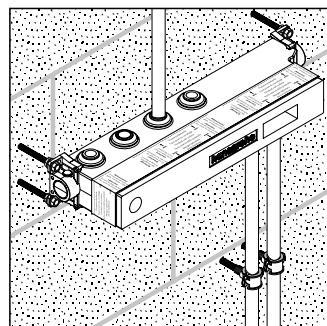
Монтаж перед стеной; здесь с разными прокладками и шурупом-шпилькой M 10
