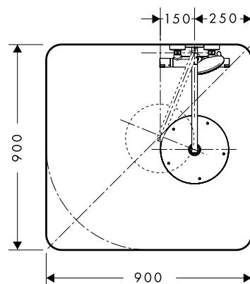
Showerpipe можно с легкостью установить на короткой или длинной стене над ванной – в зависимости от расположения подводов воды. Расположение верхнего душа при этом можно подкорректировать, повернув его в нужную сторону.
