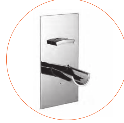
Cod. 56539/12 Gruppo lavabo a parete con bocca mm. 120 e miscelatore su piastra unica, con scatola incasso, collegamenti interni, dispositivo di regolazione portata, cartuccia progressiva Wall basin mixer with 120 mms. Spout and mixer on single plate, with built-in box, internal connections, flow regulation system, progressive cartridge
