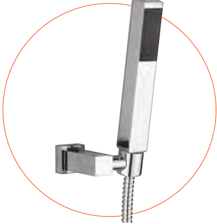
Cod. 824 Duplex minimalista quadro senza erogazione in ottone, con supporto orientabile, doccetta monogetto e flessibile doppia aggraffatura mm 1500, 1/2" ff conico. Square shower set with orientable bracket, single function handshower and 1500 mms double interlock hose, 1/2" ff conical.
