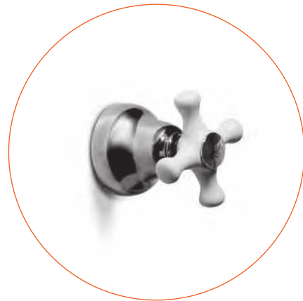
Cod. 16525/5 Deviatore 5 vie (2 entrate 3 uscite) 5 ways diverter (2 in - 3 out)
