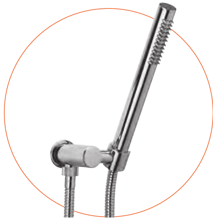
Cod. 830 Duplex minimalista tondo con erogazione, supporto orientabile, doccetta monogetto e flessibile doppia aggraffatura mm 1500, 1/2" ff conico. Round shower set with water supply elbow, orientable bracket, single function handshower and 1500 mms double interlock hose, 1/2" ff conical.
