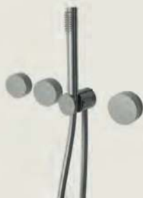
■ ART. A217A/A217B Gruppo vasca incasso (1/2") con deviatore, doccetta, senza bocca. Built-in bathtub set (1/2") with diverter, handspray, without spout. Mitigeur baindouche à encastrer (1/2") avec inverseur, douchette, sans bec. UP-Wannen und Brausemischer (1/2") mit Umsteller, Handbrause, ohne Auslauf. Grupo baño ducha empotrado (1/2") con desviador, teleducha, sin caño.
